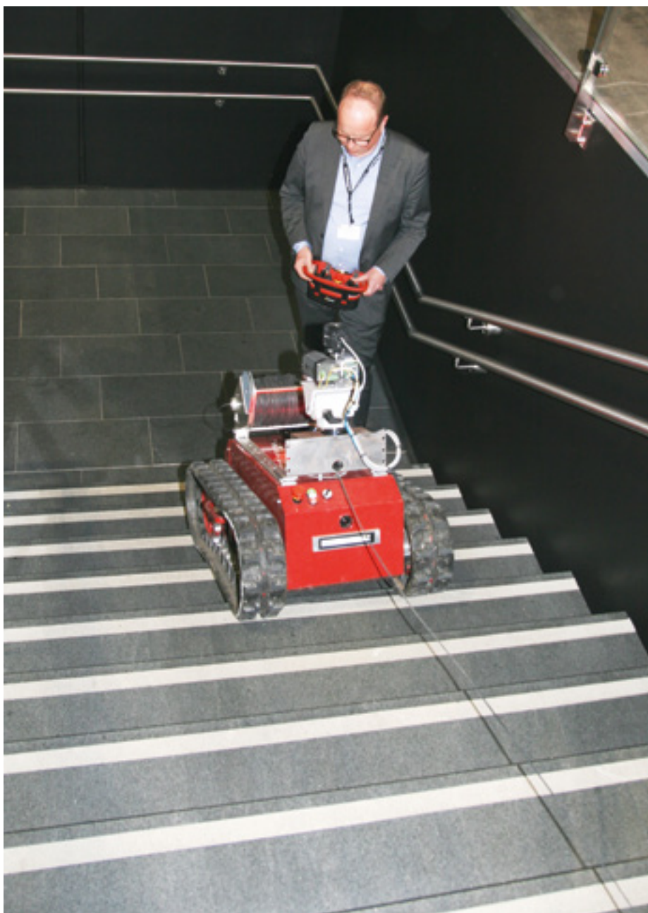
Ikke noe problem å kjøre FUMO ned en trapp.
