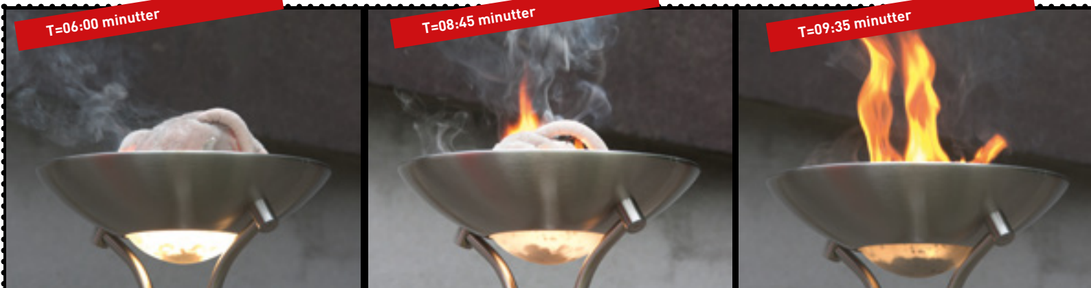
Figuren viser hendelsesforløpet når et kosedyr av uspesifisert kunstfiber dekker en halogenpære på 350 W. Øverst i bildene angis tidspunktet fra kosedyret ble lagt på den tente pæren.
