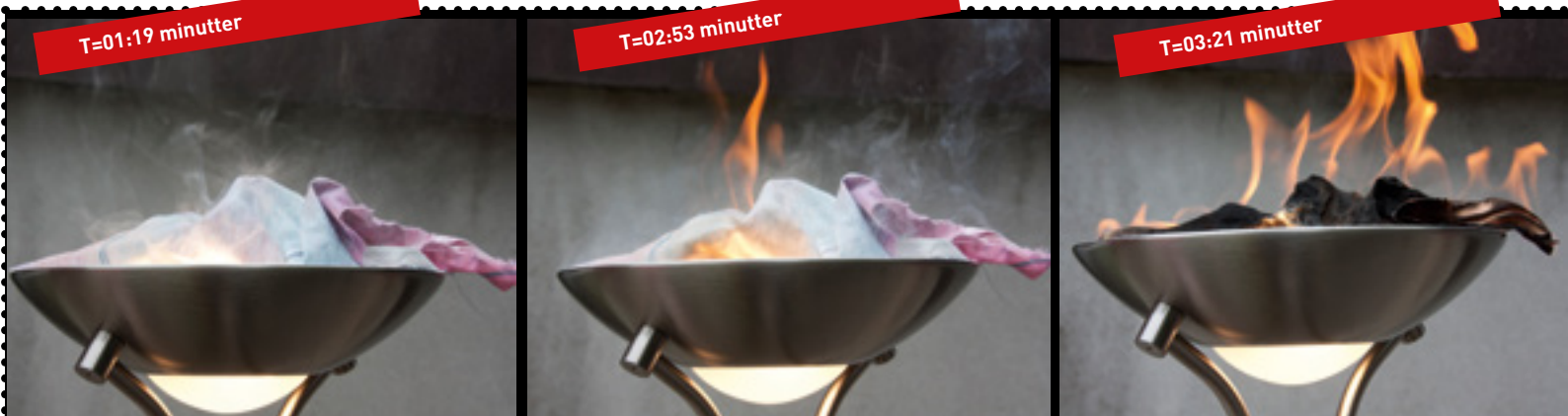
Figuren viser hendelsesforløpet når et stykke bomullsgardin dekker en halogenpære på 350 W. Øverst i bildene angis tidspunktet gardinstykket blir lagt på den tente pæren.
