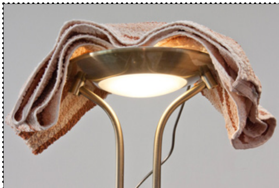
Stålampe med LED-pære, tildekket med fire lag frotté. Temperaturmåleren ligger mellom frottélaget og pæren.
