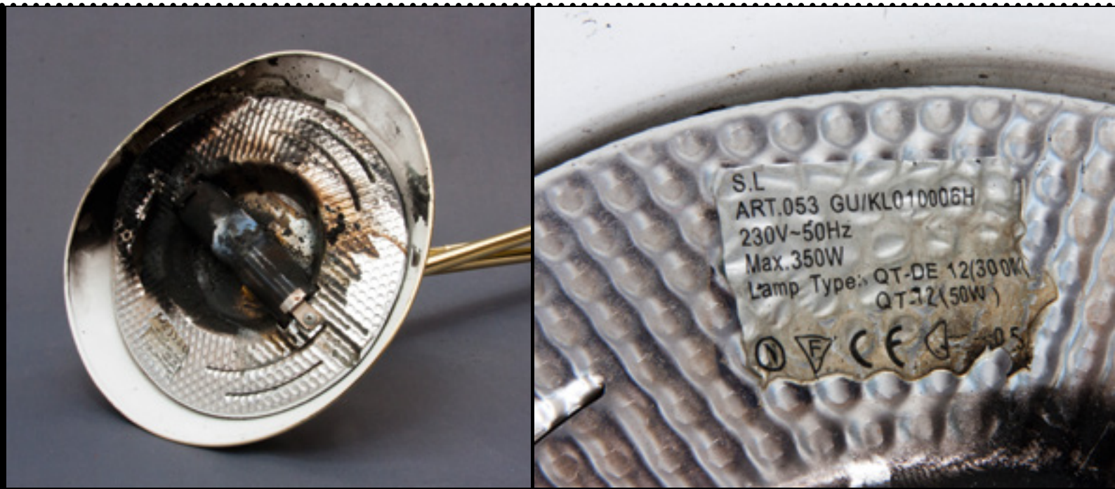
Den brannskadde lampen. Halogenpæren er montert bak det beskyttende glasset.
